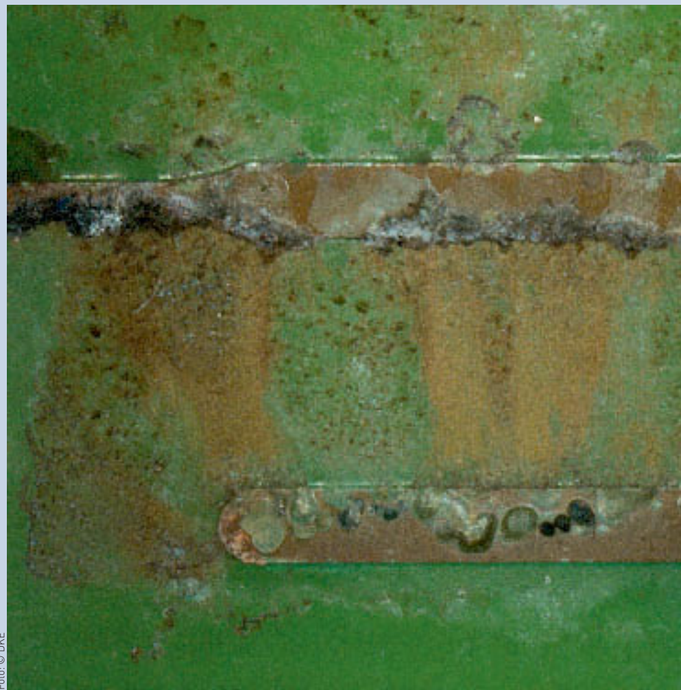
Abb. 1: Elektrische Beanspruchung mit dem bloßen Auge sichtbar – Schädigungen und Ablagerungen an einem Prüfling
